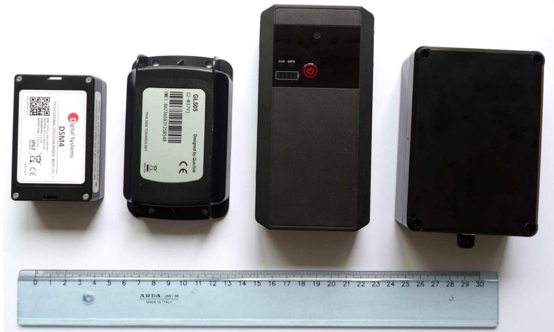
Das erste Gerät von links ist von der Firma QTrack ein Batteriegerät mit handelsüblichen Batterien (2 Stk. CR123) Der Tracker ist der kleinste bei unserem Test – er wird mit einer Tasche oder jetzt mit Tasche oder Schlauch geliefert, die auf die handelsüblichen Bänder für Schafe oder Rinder eingefädelt werden.
